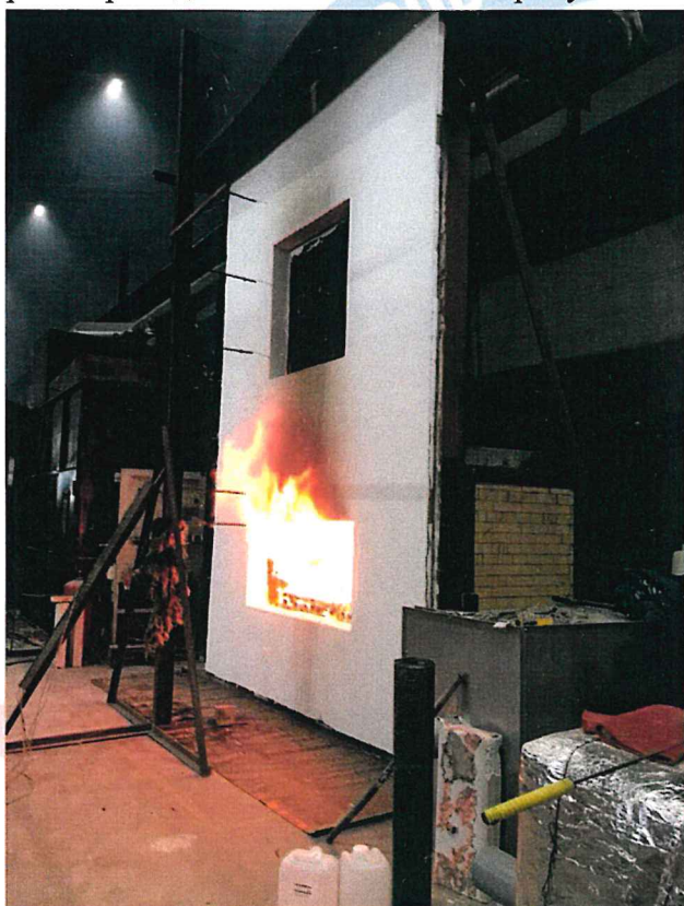
Рис. 4. Внешний вид образца на 10-й минуте испытания.
