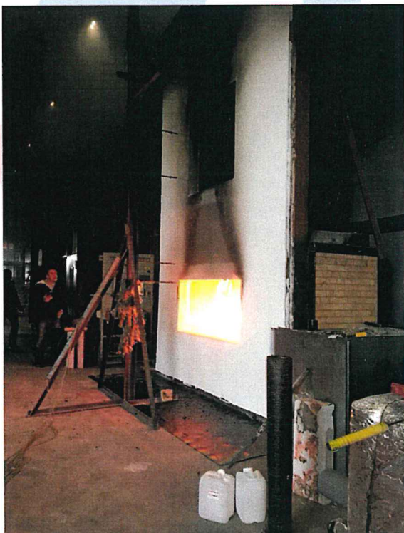
Рис. 8. Внешний вид образца на 35-й минуте испытания.
