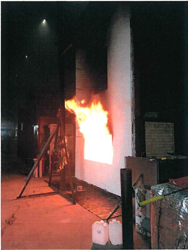
Рис. 6. Внешний вид образца на 20-й минуте испытания.
